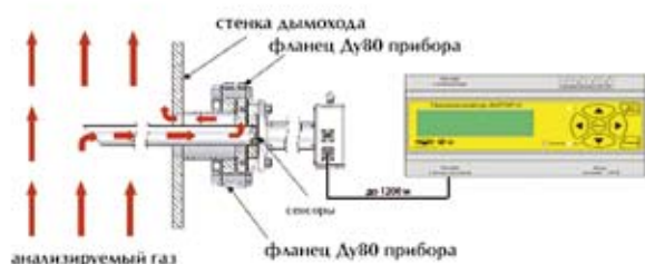
Рисунок 1. Газоанализатор «АНГОР-С» и схема динамического отбора пробы
